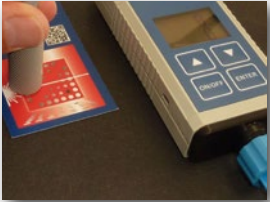
Detektion eines verdeckten Merkmals im Druck Detection of a hidden characteristic in print
