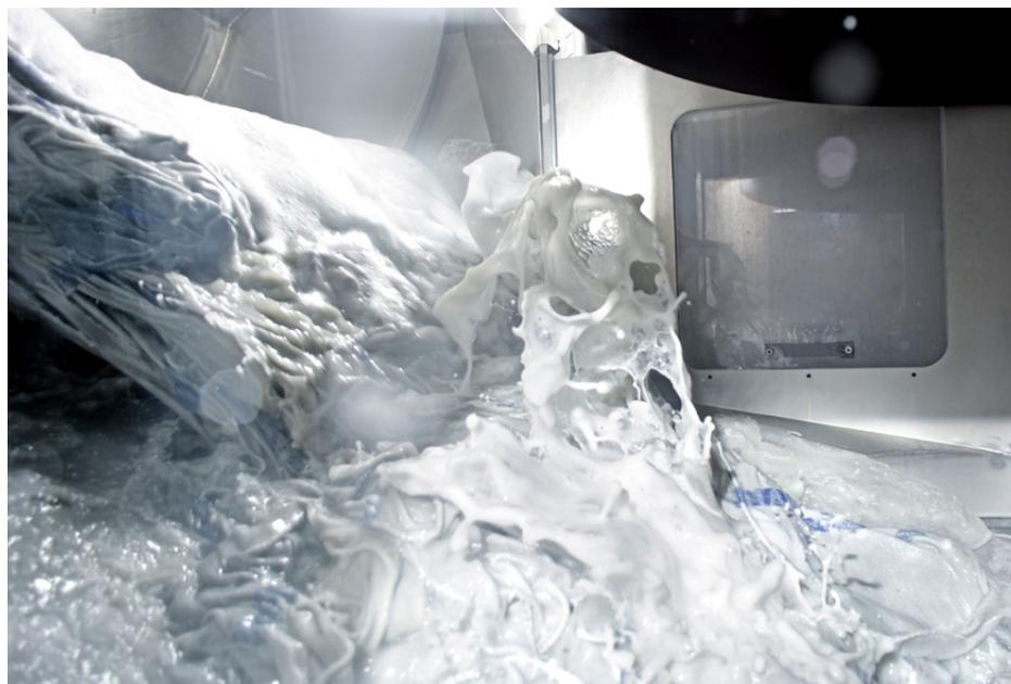
a una tecnologia innovativa, i lubrificanti contenuti nei panni sporchi vengono filtrati e riutilizzati per riscaldare le linee di lavaggio e asciugatura. E questo è il bilancio annuale: una copertura dell'80% del fabbisogno di energia e un risparmio di sette milioni di litri di combustibile. Inoltre, l'ultramoderno sistema a cascata delle linee di lavaggio assicura un uso parsimonioso dell'acqua. I detersivi, utilizzati comunque in
